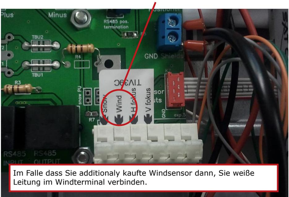
Im Falle dass Sie additionaly kaufte Windsensor dann, Sie weiße Leitung im Windterminal verbinden.
