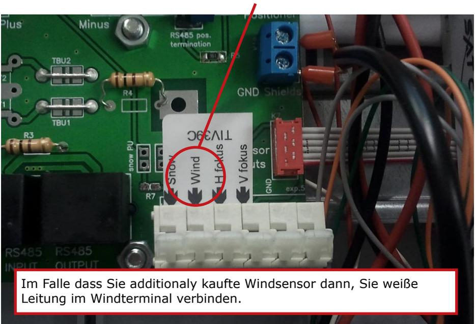
Verbinden Sie das weiße Kabel mit dem Anschluss für den Wind Sensor.
